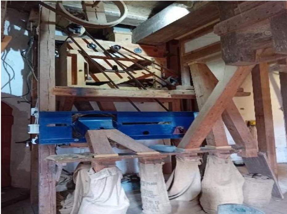
Die hölzerne, von Hand zu betätigende Schrotmühle wurde wieder mit zwei Mahlsteinen ausgerüstet. Sie arbeitet im Prinzip wie die große Mühle. Das Tonbett für den unteren Stein (Ligger) erstellte Ulrike de Buhr. Die Handmühle steht zu Vorführzwecken im Erdgeschoss.
