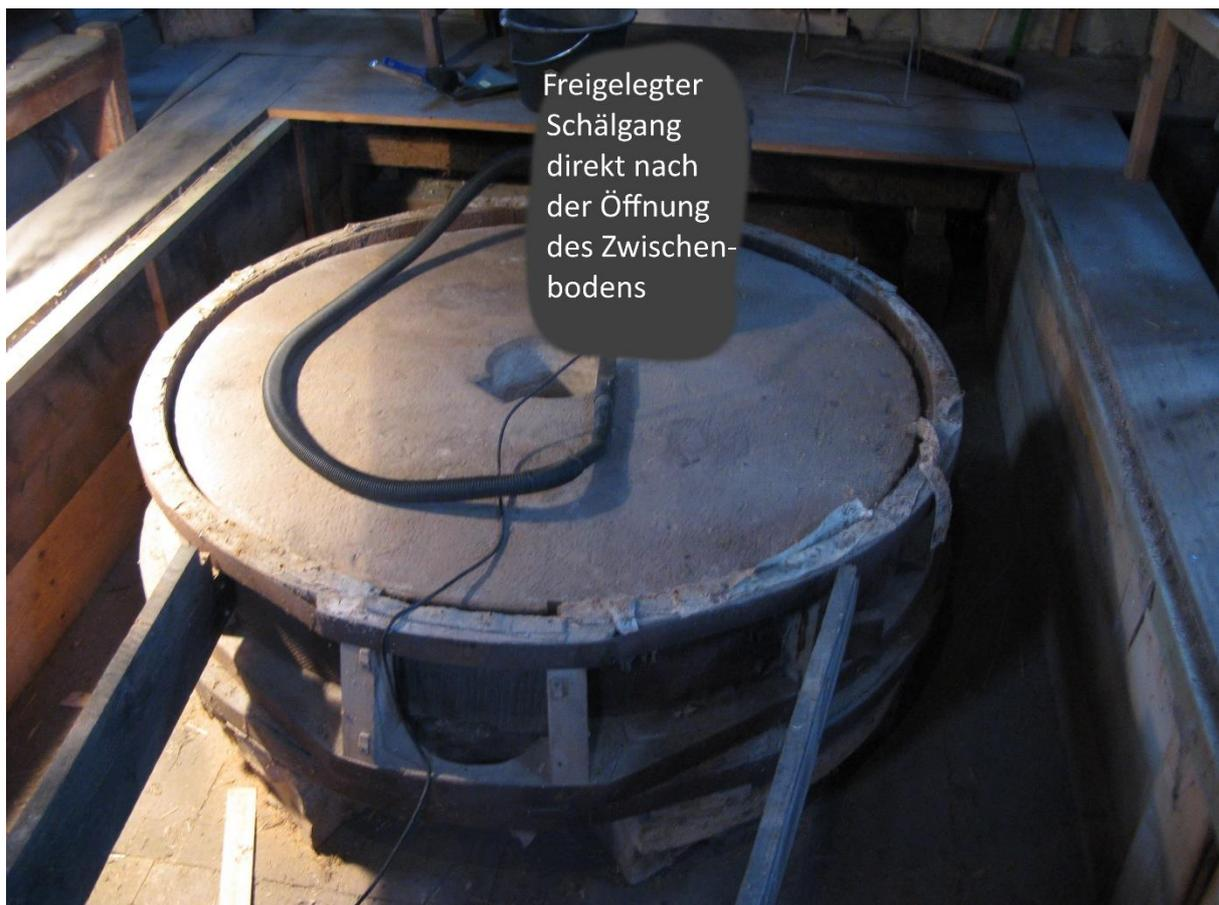
Dann legte man den Schälengang komplett frei. Dieser wird auch als Peldegang bezeichnet und dient der Herstellung von Graupen aus Gerste.
